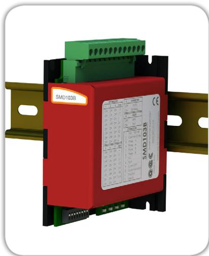
L'SMD103B è un azionamento passo-passo di tipo chopper in grado di controllare motori fino a 4A in modalità Step e Direzione con una risoluzione massima di 3200 step per giro. Le sue misure estremamente compatte (90 x 80 x 30), lo stadio di potenza ad elevata efficienza e la sua semplicità di installazione e utilizzo, lo rendono la scelta perfetta per le applicazioni a media-bassa potenza. L'interfaccia di ingresso può lavorare con segnali sia a +24Vdc (PNP o NPN), sia con segnali TTL.
