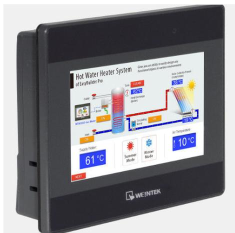
Il pannello operatore MT8052iP è dotato di un display TFT da 4,3" a 16M di colori retroilluminato a led. Dispone di una porta seriale, di una porta Ethernet e di una porta USB per il collegamento di una chiavetta. La programmazione di questo HMI può essere effettuata tramite PC con il software Easy Builder Pro.
