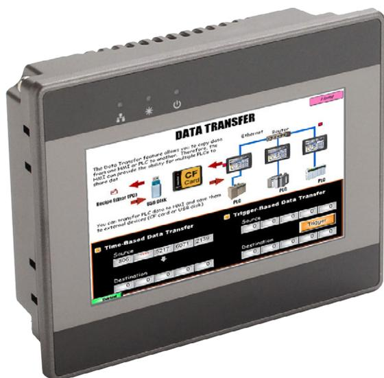
Il pannello operatore MT8073iE è dotato di un display TFT da 7" a 16,7M di colori retroilluminato a led. Dispone di due porte seriali, due porte Ethernet e di una porta USB per il collegamento di una chiavetta. La programmazione di questo HMI può essere effettuata tramite PC con il software Easy Builder Pro.
