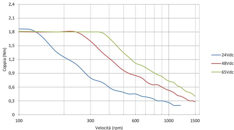
Curve di coppia realizzate con torsionmetro AEP mod. MRT250NM
