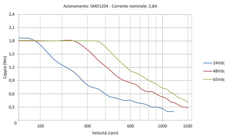
Curve di coppia realizzate con torsionmetro AEP mod. MRT250NM
