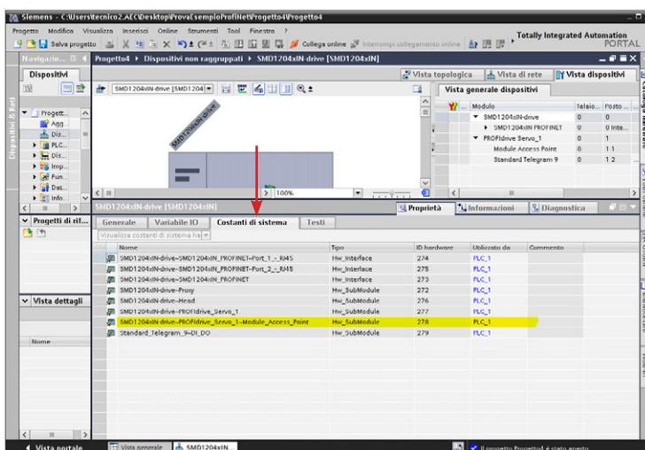
Aprire la sezione “Costanti di sistema” e prendere nota dell’ID hardware dello slot “Module access” che sarà necessario per configurare il blocco programma di comunicazione aciclica.
