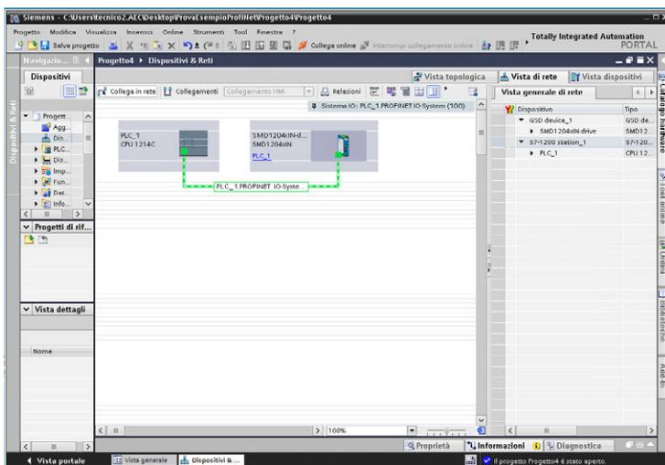
Selezionare il tab “Vista di rete” ed associare il dispositivo ad un controller Profinet, trascinando la rete dal quadratino verde del PLC ad quadratino verde dell’azionamento.
