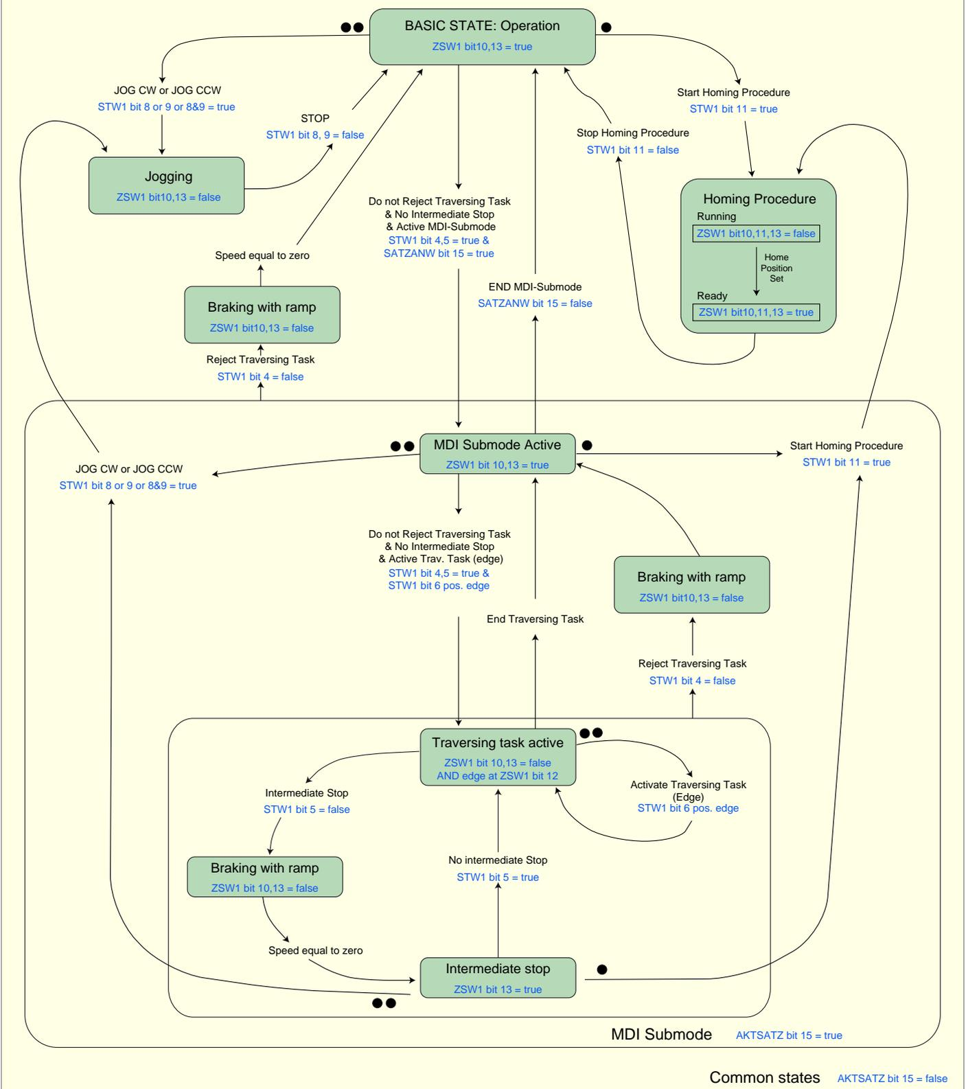
Il seguente diagramma mostra la sequenza di bit per attivare la procedura di azzeramento.
