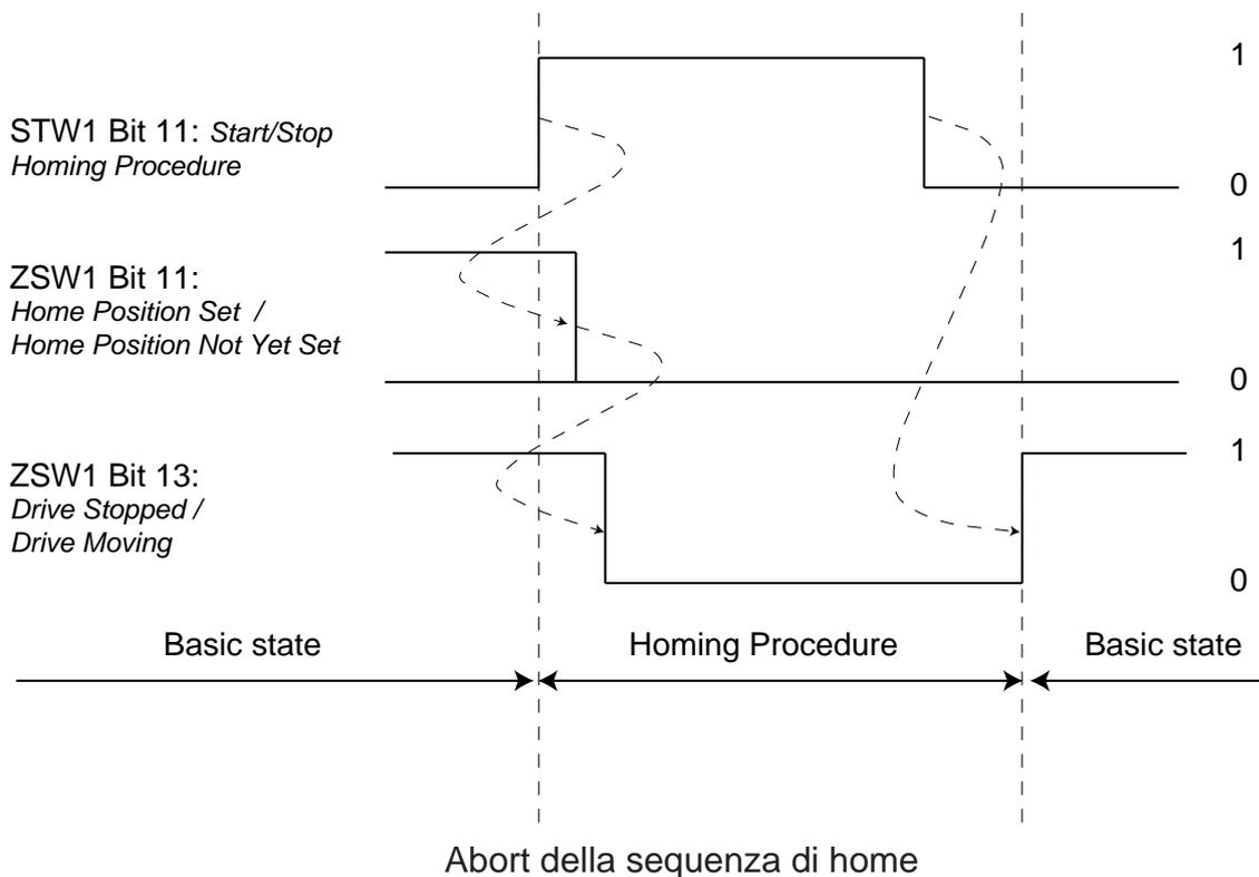
Il seguente diagramma mostra la sequenza di bit per attivare una traversing task.
