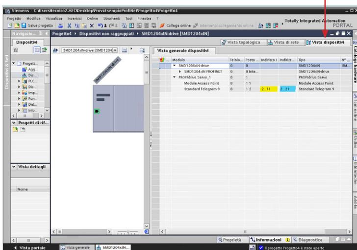
Ritornare nella tab “Vista dispositivi” ed impostare gli indirizzi di input/output desiderati per la comunicazione aciclica o lasciare quelli impostati di default. Questi valori saranno necessari nella configurazione dei blocchi di programma PLC.
