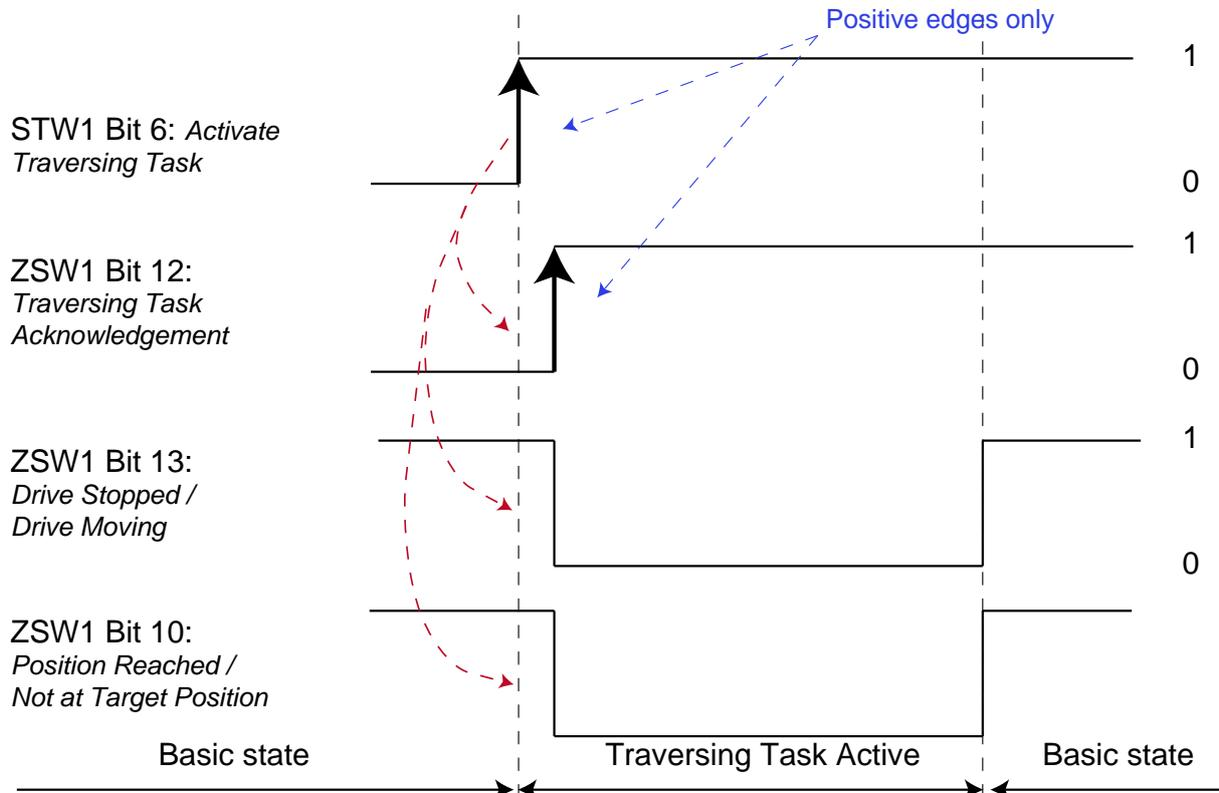
Il seguente diagramma mostra la sequenza di bit per attivare una nuova traversing task o di un nuovo setpoint prima della fine del task precedente.
