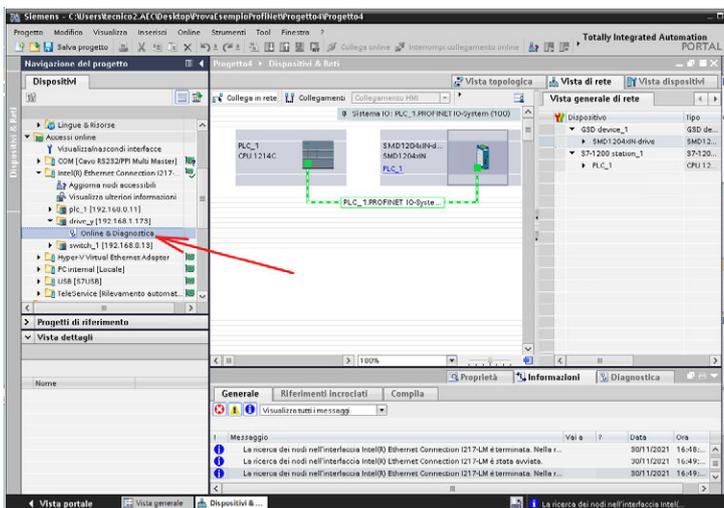
Vengono visualizzati tutti i dispositivi accessibili sull’interfaccia. Usando il MAC ADDRESS del drive, selezionare il dispositivo e cliccare su “Online & Diagnostica”.
