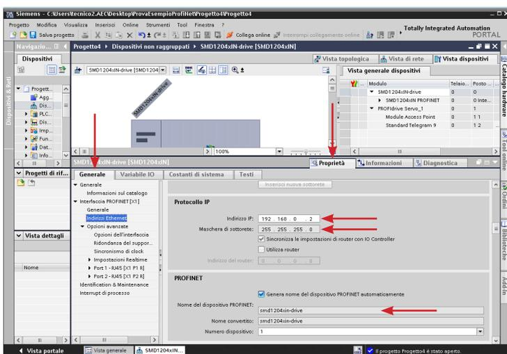
Aprire il tab “Proprietà” presente in basso a sinistra e nella sezione “Indirizzi Ethernet” impostare l’indirizzo IP del dispositivo, la net mask e il nome che si vuole dare al dispositivo Profinet.
