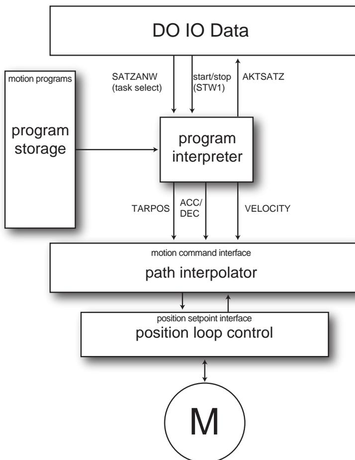
L'esecuzione di un programma di movimento, o il cambio ad un nuovo programma, durante l'esecuzione di un blocco di posizionamento può essere ottenuto selezionando il nuovo blocco tramite SATZANW (mentre il bit 15 è a 0) e abilitando il bit 6 di STW1.
