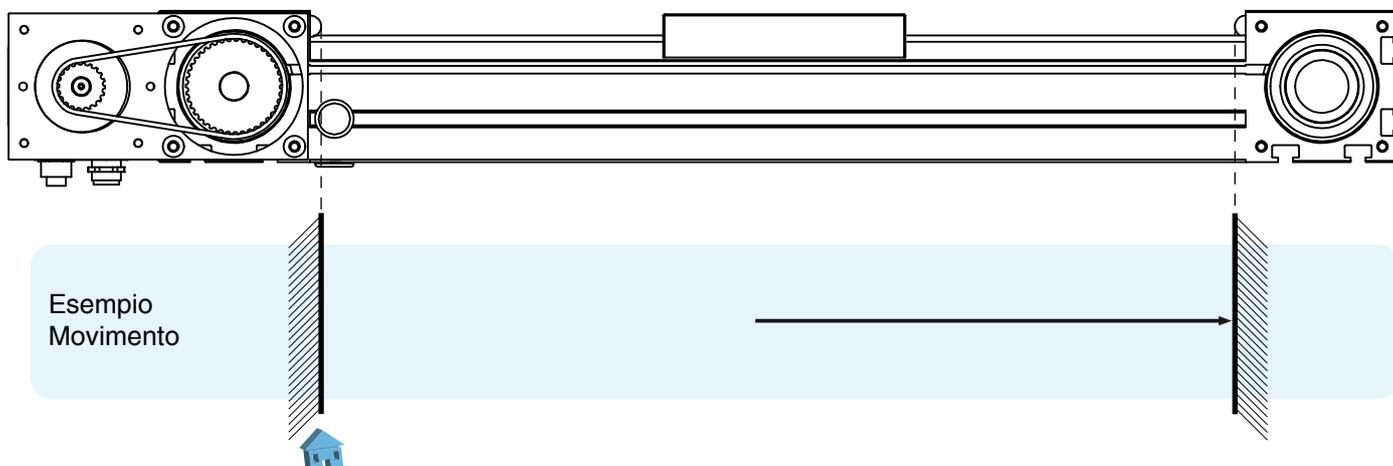
Il motore si muove in direzione avanti fino alla battuta meccanica dell'asse; quando il motore si ferma in battuta, l'encoder smette di incrementare la quota. Quando la quota encoder rimane invariata per il tempo impostato sul registro Rhtimcoll, viene azzerata la posizione attuale (Rposact) e impostato il flag di asse azzerato (bit 2 di Rstsfly).
