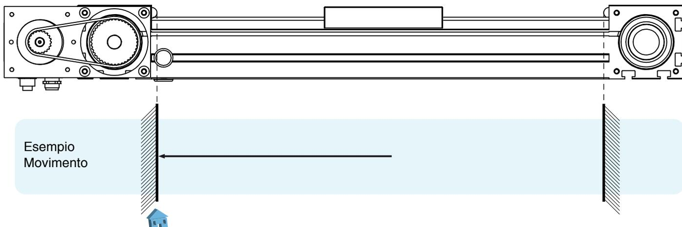
Il motore si muove in direzione indietro fino alla battuta meccanica dell'asse; quando il motore si ferma in battuta, l'encoder smette di incrementare la quota. Quando la quota encoder rimane invariata per il tempo impostato sul registro Rhtimcoll, viene azzerata la posizione attuale (Rposact) e impostato il flag di asse azzerato (bit 2 di Rstsf1g).
